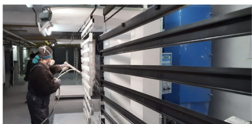
ЦЕХ ПОРОШКОВО-ПОЛИМЕРНОЙ ПОКРАСКИ
